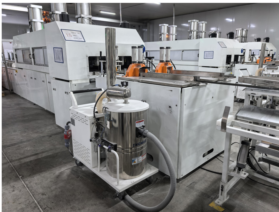
图 3-3 本项目切割设备及配套的滤筒除尘设备
