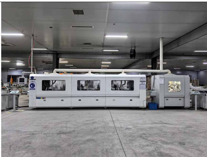
图 3-4 本项目密闭式打磨机及废气收集管线
