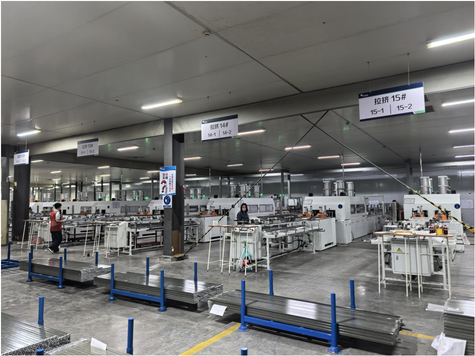
图 3-1 本项目拉挤生产线
