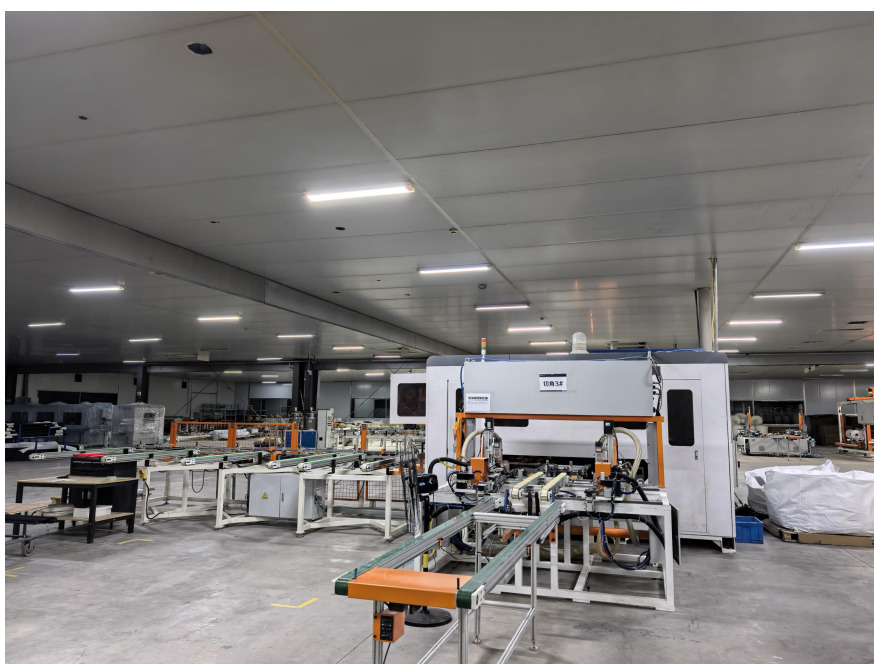
图 3-5 本项目密闭式斜切打孔机及废气收集管线
